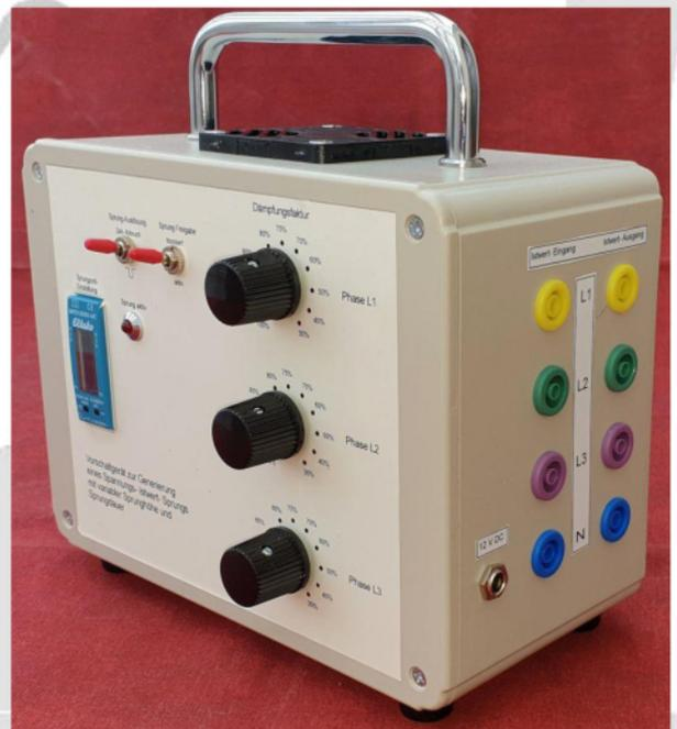
Der an die Spannungswandler angeschlossene Istwert- Eingang ist für eine Spannung von  $3 \times 120 \text{ V} / \sqrt{3}$  ausgelegt und sollte daher für die meisten Anwendungsfälle ausreichend sein.
